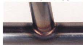
Hrúbka plechu: 2 mm Zvárací prúd: 150 A Pulzná frekvencia: 10 Hz
