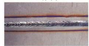
Hrúbka plechu: 2 mm Zvárací prúd: 120 A Pulzná frekvencia: 5 Hz
