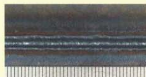
[Prúd: 125 A Napätie: 18 V Rýchlosť zvárania: 150 cm/min Priemer drôtu: 1,2 mm Hrúbka základného materiálu: 1 mm]
