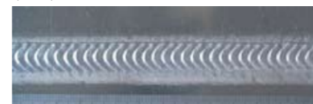
Hliník; Prúd: 160 A; Napätie: 19 V; Rýchlosť zvärania: 60 cm/min; Priemer drôtu: 1,2 mm; Hrúbka materiálu: 4 mm
