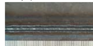
Oceľ; Prúd: 125 A; Napätie: 18 V; Rýchlosť zvärania: 150 cm/min; Priemer drôtu: 1,2 mm; Hrúbka materiálu: 1 mm
