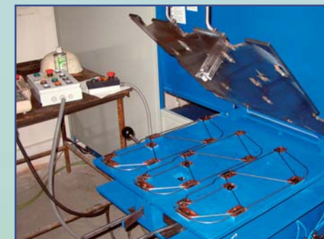
Drôtené polotovary upnuté v prípravku na otočnom stole
