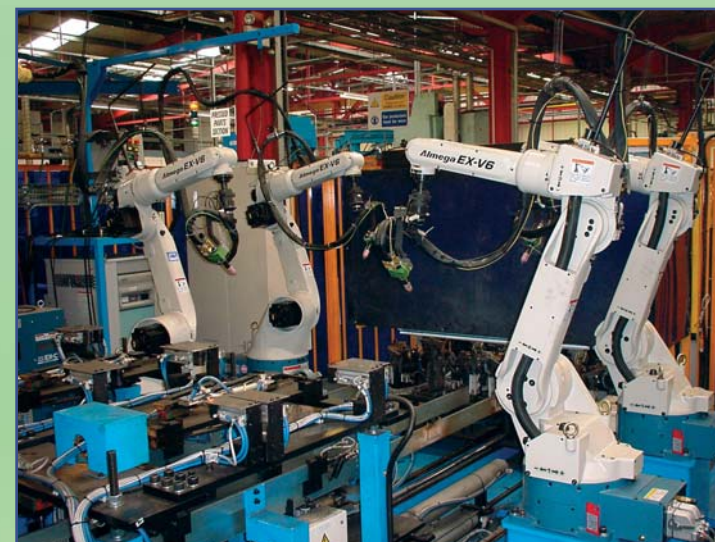
Riadenie viacerých robotov OTC Daihen jednou riadiacou jednotkou
